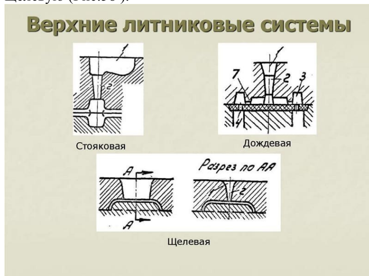
Рис. 58 . Примеры верхней литниковой системы
